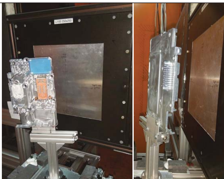
Egy komplex alumíniumöntvény neutrontomográfias vizsgálatra előkészítve a Budapesti Neutron Centrum RAD mérőhelyén
